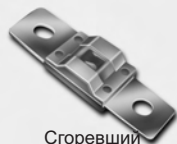
Сгоревший предохранитель 1VQA4037
