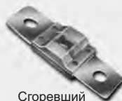
Сгоревший предохранитель 1VQA4037
